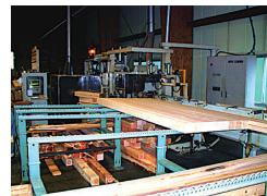
木造軸組工法の構造材を一棟単位で製作するプレカット・システム。良質な西川材とコンピューター制御による精度の高い加工、そして徹底した品質管理が、均質かつ高品質な製品のスピーディーな提供を可能にしました。このプレカット・システムを導入する事により安定した構造体が実現し、建築物のクオリティを高めることができます。
