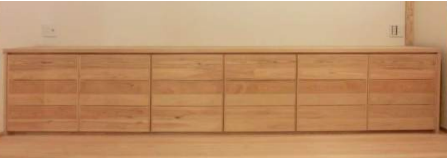
木目を揃えるため、一枚の幅ハギ材から製作した家具面材。
